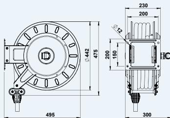
**DE** Schlauchaufroller zur Abgabe von versch. Flüssigkeiten, wie z.B. Diesel-Kraftstoff, AdBlue, Luft und Wasser mit bis zu 1" Schlauchdurchmesser. Schwenkbare Arme für 3 versch. Positionen (s.Abb. A-B-C). Serienmäßig: Verbindungsrohr, Schlauchführung mit 4 Rollen bei den angegebenen Versionen, seitliche Schutzverkleidungen (nicht verfügbar für mod. Atex). Optional: Verbindungsschlauch, Schwenkkonsole und Wandbefestigung, Antientgleisungshalterung.
